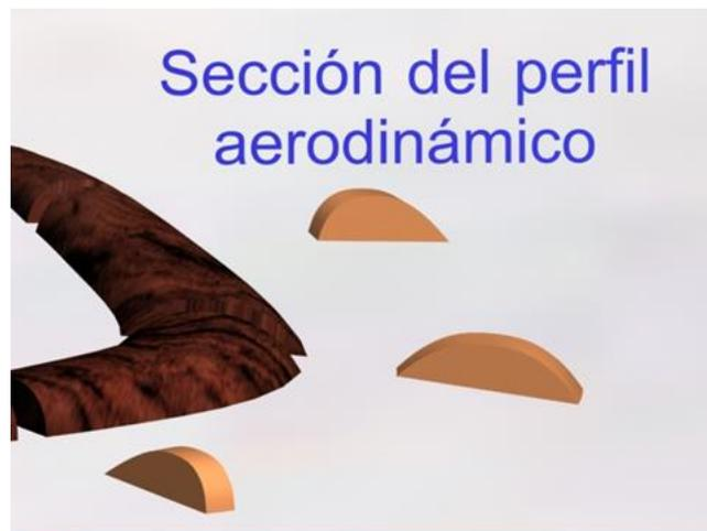
*Las alas de un bumerán son superficies de sustentación, como las de un aeroplano. Al moverse a través del aire, su perfil genera una fuerza de sustentación, en la figura se muestran distintas secciones del Bumerán, que varían en función de su posición relativa.*
